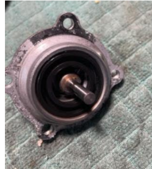
Bovenhuis van pompje gedemonteerd
