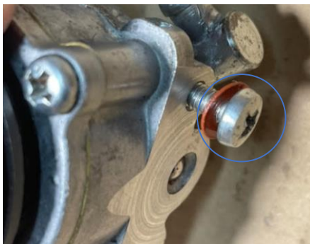
Afstelplaat volledig volgas ( laag toeren 6000 rpm)
