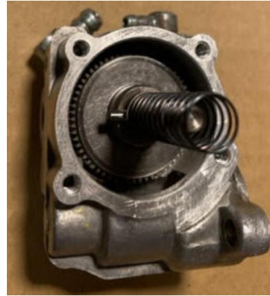
Bovenhuis met keerring nieuw en bovenhuis met nieuwe pakking en keerring
