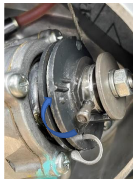
Afstelplaat volledig volgas ( hoog toeren 9000 rpm meer olie)
